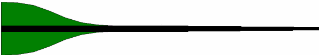
Obr. 5.46: Struktura symetrizačního Balunu.
